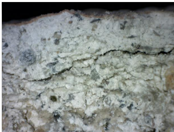
Vzorky F/1 a F/2 – výstavba povrchových úprav při makroskopickém zvětšení.
