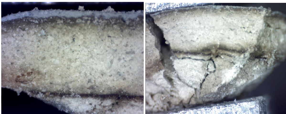
Vzorky G/1 a G/2 – výstavba povrchových úprav při makroskopickém zvětšení.
