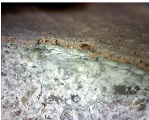
Vzorky C/1 a C/2 – výstavba povrchových úprav při makroskopickém zvětšení.
