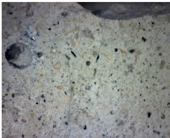
Charakteristický vzhled románského cementu při makroskopickém zvětšení.
