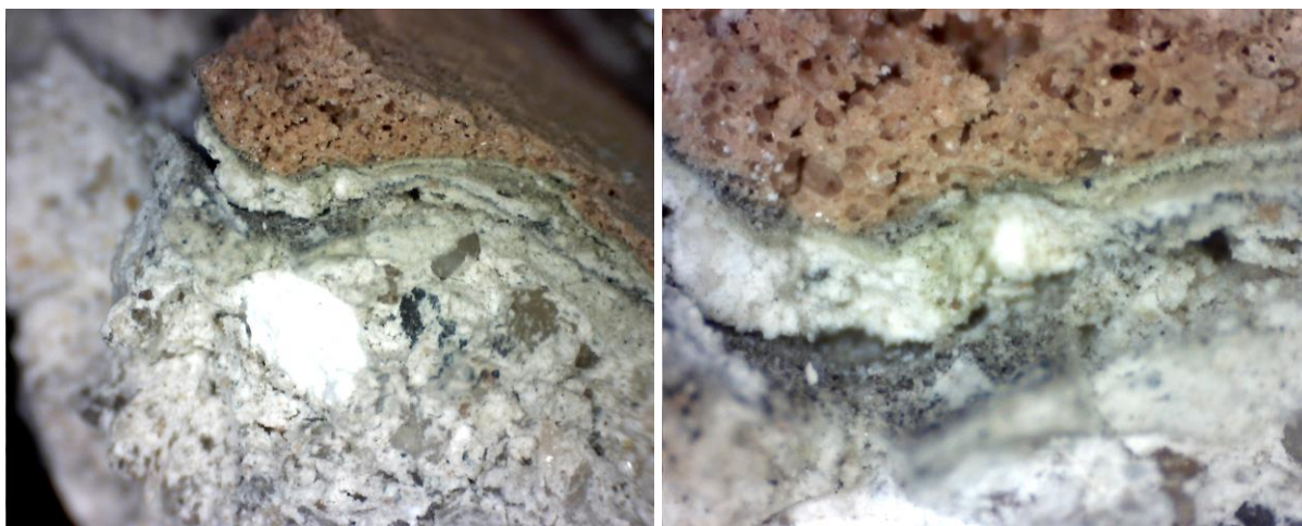
Vzorky C/5 a C/6 – výstavba povrchových úprav při makroskopickém zvětšení.
