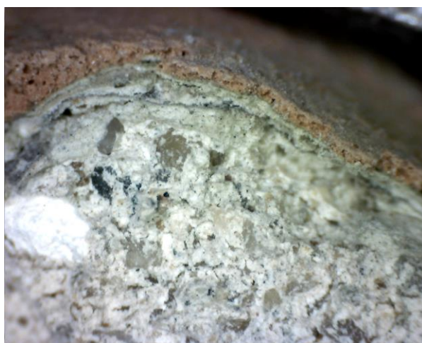
Vzorky C/1 a C/2 – výstavba povrchových úprav při makroskopickém zvětšení.
